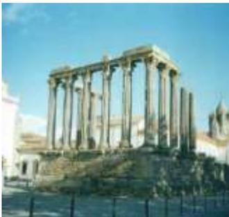
При постройке храма в честь богини Дианы римляне взяли пропорцию, которой отличаются стройные женщины: толщина колонны составила лишь  $\frac{1}{8}$  ее высоты. Благодаря этому колонны казались выше, чем она была на самом деле, как раз за счет уменьшения толщины. В архитектуру вошли оба вида колонн, сохраняющие одна мужскую, другая женскую пропорции в отношениях между основанием и высотой.
